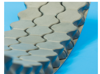
SiC-DuktAr-Elemente mit Stahlblech-Backing.
