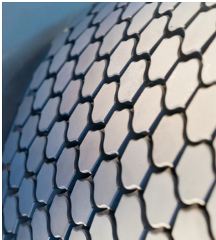
Keramisch gepanzerte Fläche mit konvex gewölbter Kontur.
